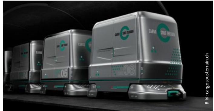
Beispiel Cargo sous terrain: Die Transporteinheiten fassen eine Palette, fahren auf Rädern und verfügen über einen elektrischen Antrieb mit Induktionsschiene.
