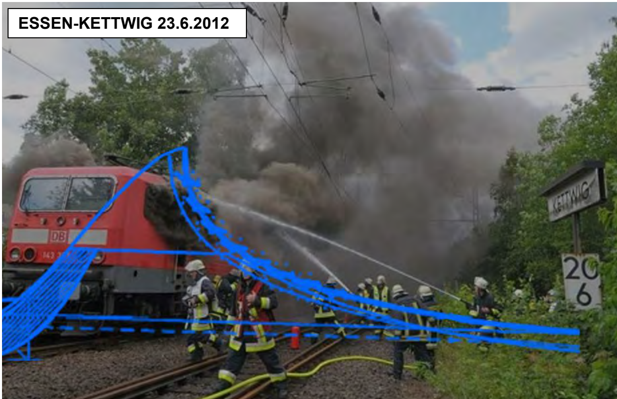
Abb. 4.6.1.3 Rauchausbreitung (aus brennender E-Lok) in den Aufenthaltsbereich, Windstille
