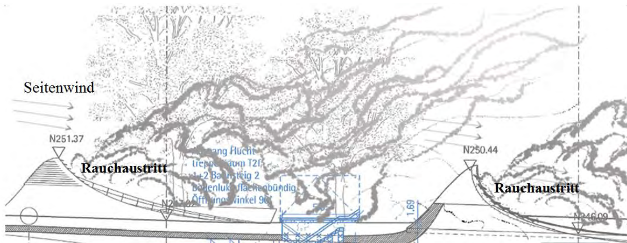
Abb. 4.6.2.1 Rauchausbreitung aus Lichtaugen in den Aufenthaltsbereich, leichter Seitenwind
