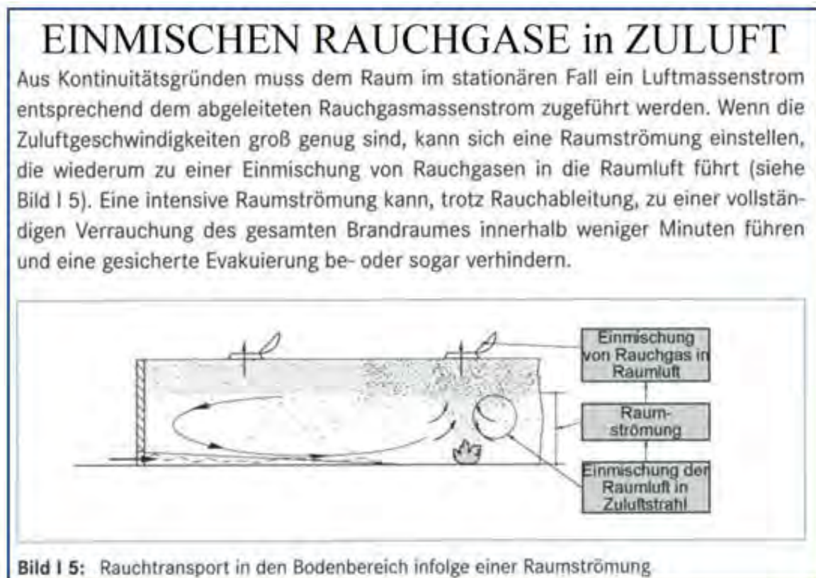
Abb. 5.2.3: Strömungsbild Rauchtransport in den Bodenbereich durch Raumströmung
