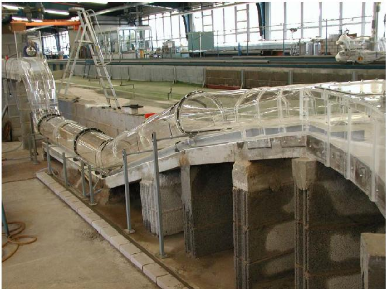
Abb. 7 Modell HS-Nesenbach im Maßstab 1:14
